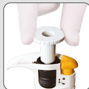
Przekręć klucz, aby zwiększyć lub zmniejszyć wskazania pipety. Szczegółowe informacje znajdują się w instrukcji obsługi.
